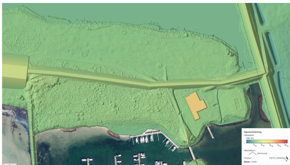
Figur 9-20: 3D præsentation af dige med sikringsniveau 400 cm DVR90 langs Brøndby Strand i Brøndby Kommune
