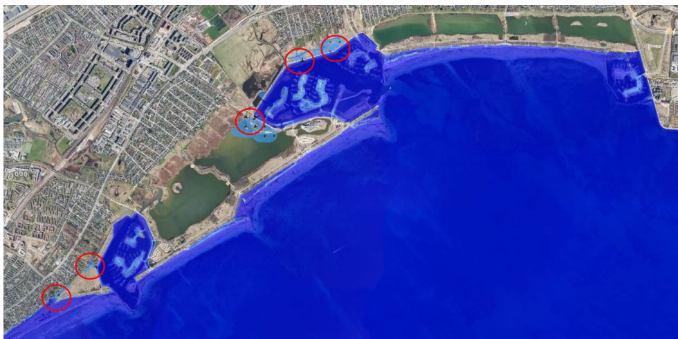
Figur 3-14 Initial oversvømmelse med modellering af vandets tidlige udbredelse og derved beredskabets forventede kritiske evakuerings-hastighed. De identificerede lavninger er markeret med røde ringe og vandet starter med at strømme ind i baglandet herfra. Maksimalvandstanden svarer til 1000 års hændelse i dag.
