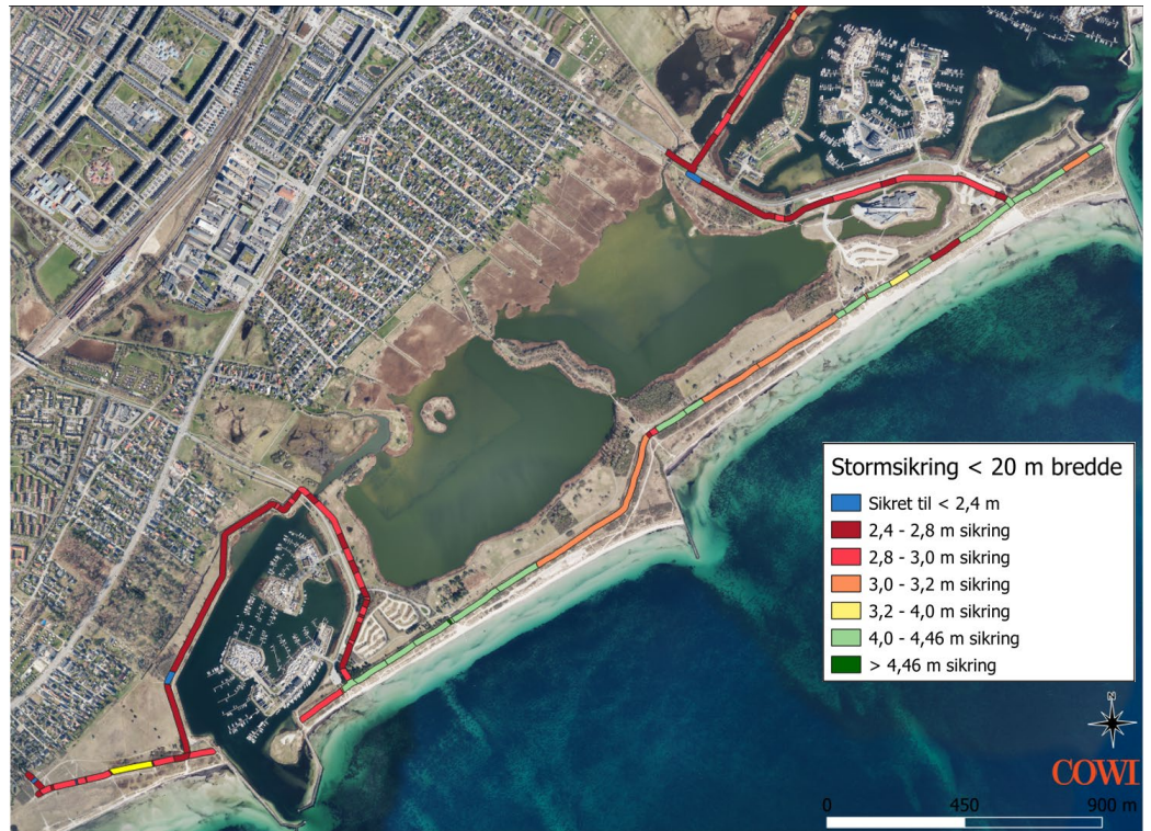
Figur 3-10: Højder for oversvømmelsesbeskyttelsen med en bredde på minimum 1 m og under 20 m, der definerer de ydre digers styrke. Vestlige del af Køge Bugt Strandpark
