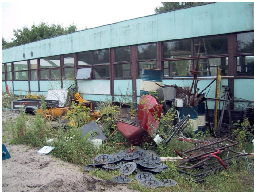
Figur 4-8 Eksempel på uacceptabelt oplag af affald ved boring
