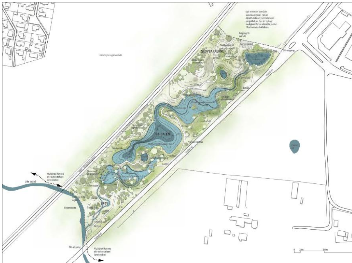
Figur 2: Principskitse for klimatilpasningsprojekt med rekreativ anvendelse for Pilemølle erhvervsområde Syd med udledning til Li. Vejle Å.
