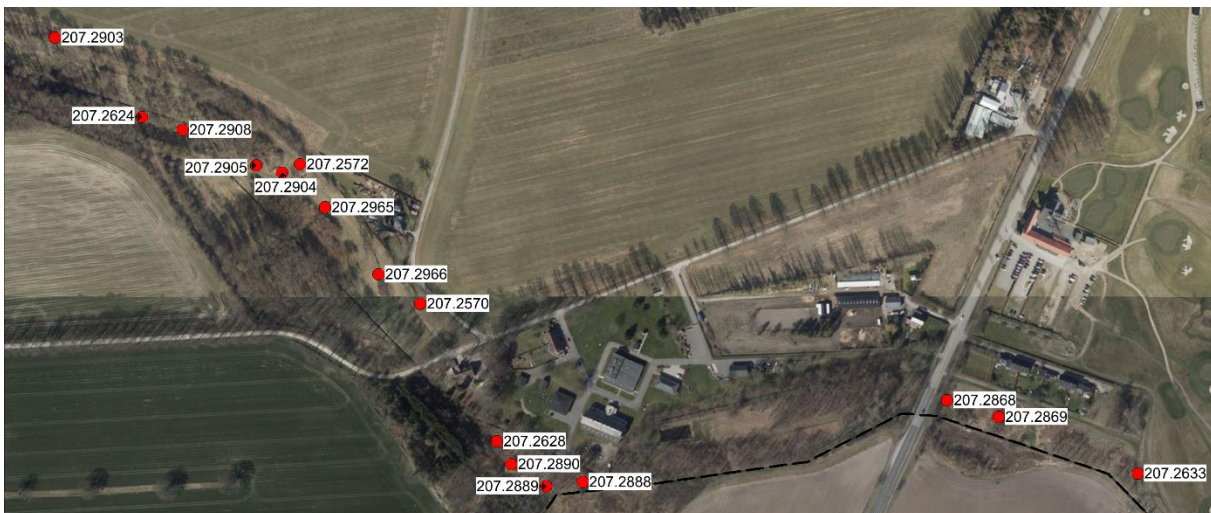
Figur 3-3. Thorsbro Kildeplads med aktive indvindingsboringer.
