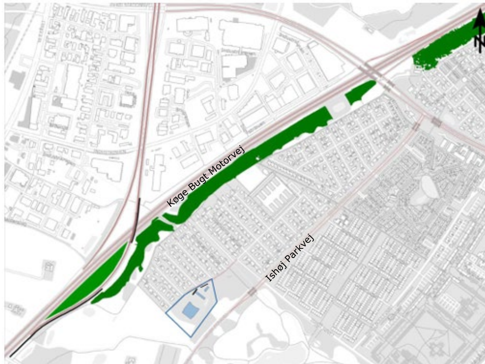
Figur 7-1 Placeringen af støjvoldene langs Køge Bugt Motorvej (grøn markering).
