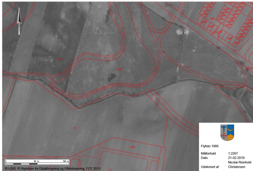
Figur 3.1: Tidligere forløb af Ll. Vejle Å og Baldersbækken ses på dette flyfoto fra 1966. Den nuværende placering af søen kan ses midt for i den øverste halvdel af fotoet. Placeringen af søen kan ses ud fra de nuværende matrikelgrænser (rød) der følger søen og vandløbet nedstrøms.
