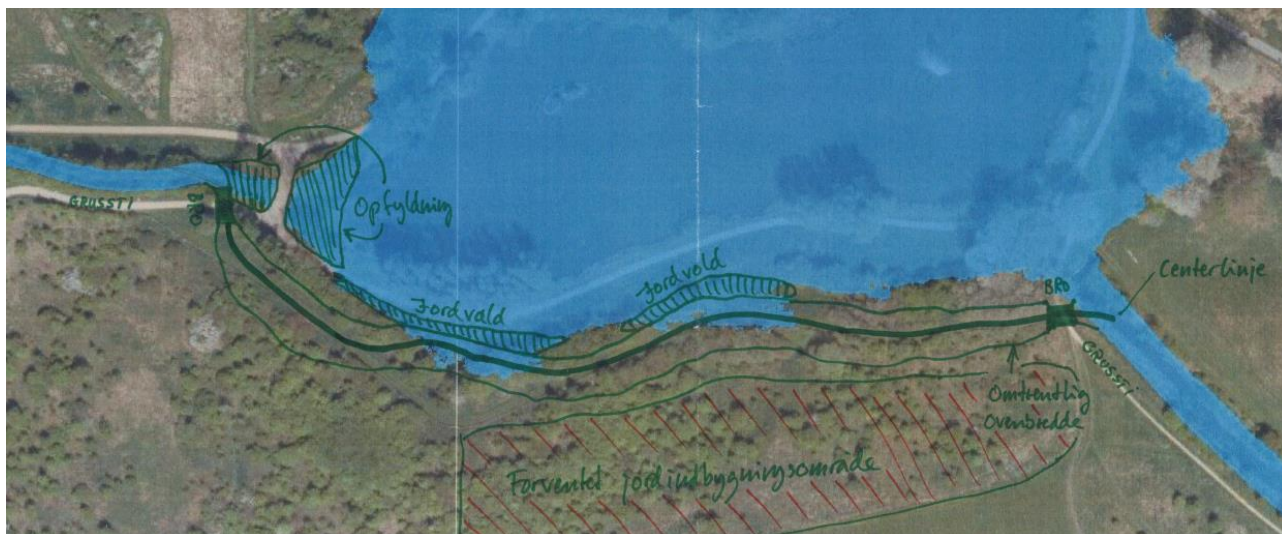
Figur 4.1: Blå farve viser arealer beliggende under kote 2,4. Forslag til tracé, broer og placering af jordvolde/diger til at adskille omløb og sø, er indtegnet i hånden på kortet.
