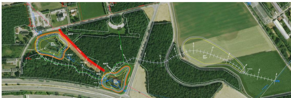
Figur 2 De planlagte tiltag for spildevandssikring ved Tranegilde
