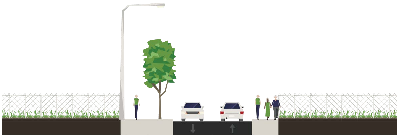
Fortov med træer og parkeringslommer Dobbeltrettet vejbane Fortov
