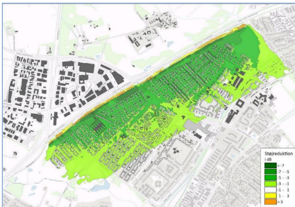
Figur 9-3 Den forventede støjreduktion ved etablering af en ny 12 meter høj støjvold. SWECO 2017
