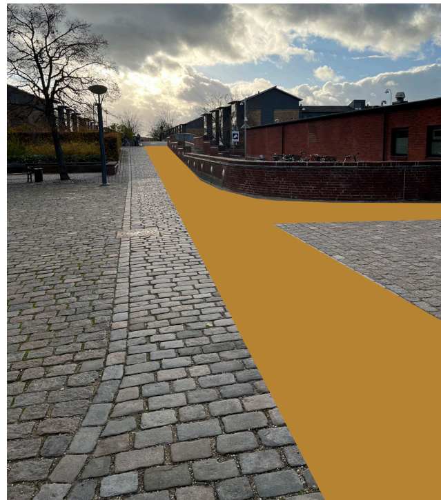
Etablering af en sti af stokhuggede brosten med en bredde på 130 cm.
