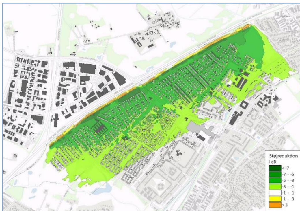
Figur 3: Den forventede støjreduktion ved at etablere en ny 12 meter støjvold [1].
