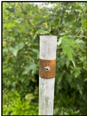
Skelafmærkning, rør med skelmærke
