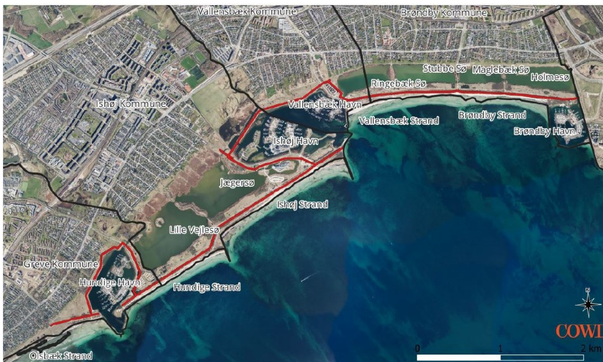
Figur 3-2: Placering af havoversvømmelsesbeskyttelse ved indre og ydre kystbeskyttelse i Køge Bugt Strandpark markeret af den røde linje. Kommunegrænserne er markeret med sort, og et ortofoto fra 2022 er brugt som baggrund.
