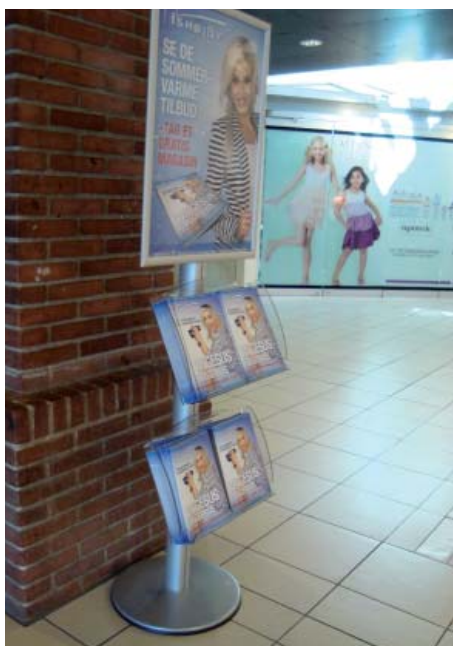
Opstillet stativ med ramme og reklamer. Er ikke tilladt på grund af brandkrav.
