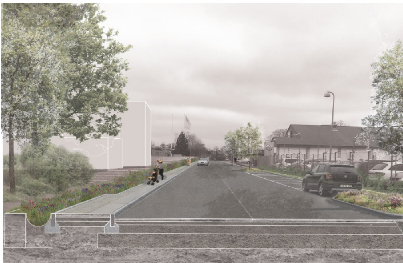
Vejopbygning og parkering på vej. Illustrationerne er udarbejdet af SWECO for Ishøj Forsyning i samarbejde med Ishøj Kommune.
