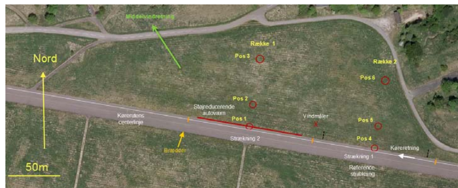
Figur 5 Orthofoto af målestrækningerne. Strækning 1 er referencetrækningen uden autoværn; Strækning 2 er med autoværn.
