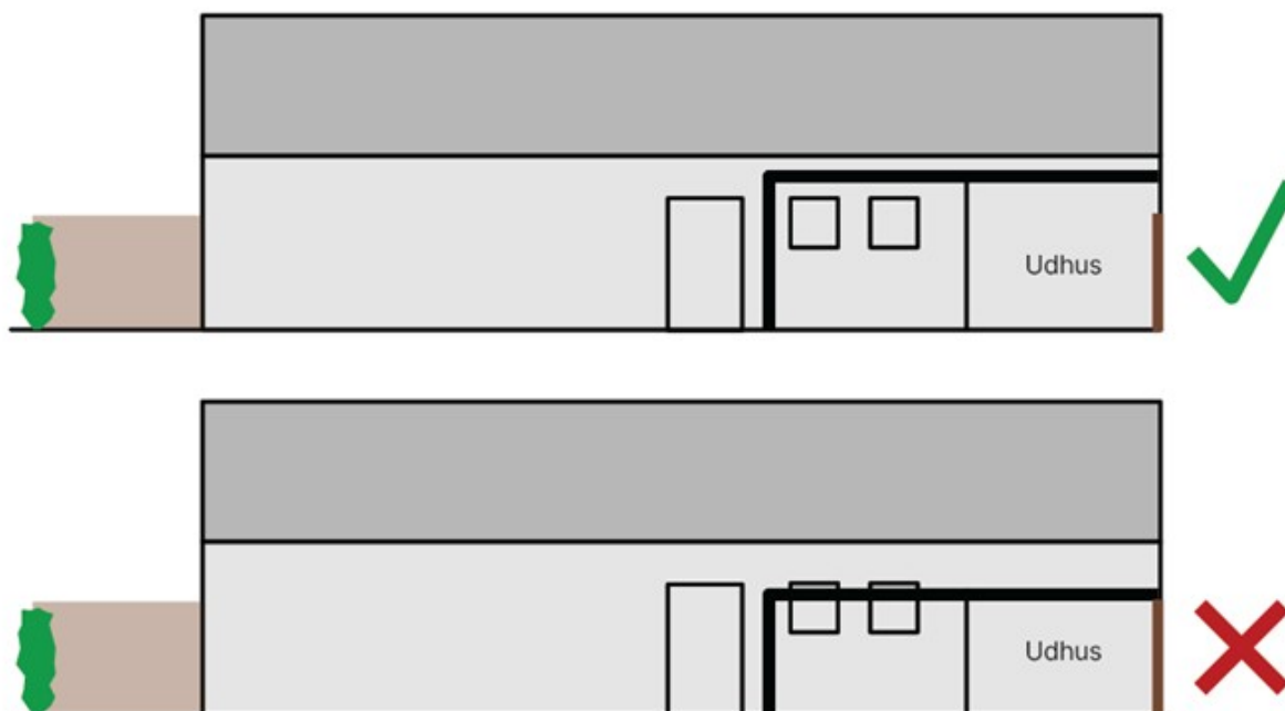
Figur 18: Princip for overdækning, hvis underkant skal flugte med eller være hævet over vinduernes øverste kant.
