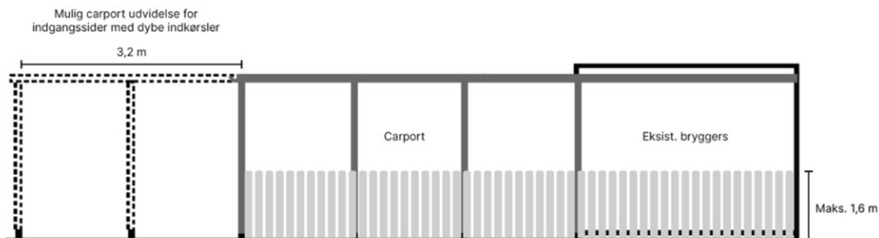
Figur 19: Princip for udvidelse af carport for boliger med dyb indgangsside, samt inddækning af pergola med tremmevæg. Tværsnit, ikke i skala.
