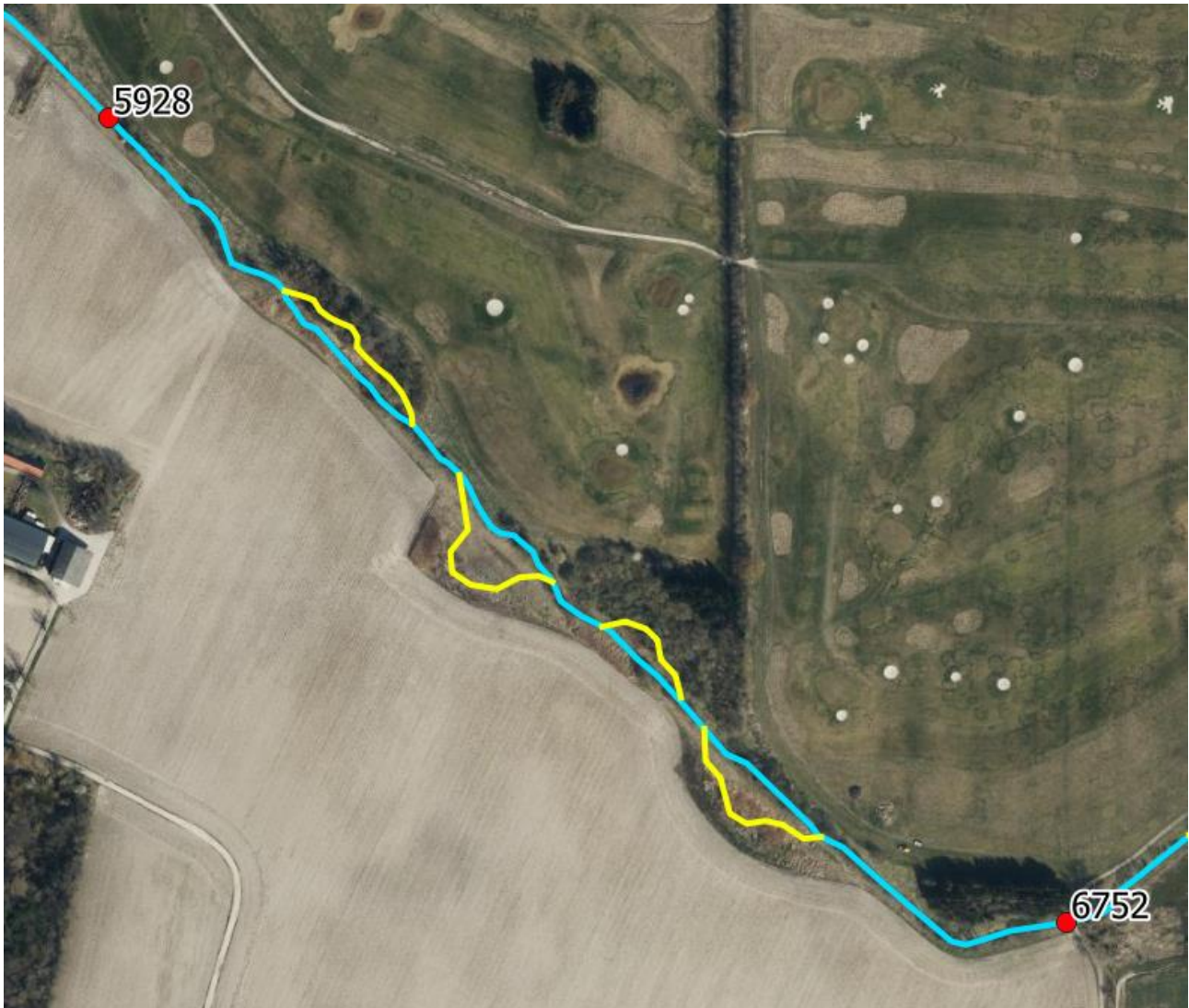
Figur 4.20: Nyt tracé er vist med gul streg. Eksisterende vandløb er vist med blå streg. Baggrundskort: Ortofoto forår 2020 (GST).
