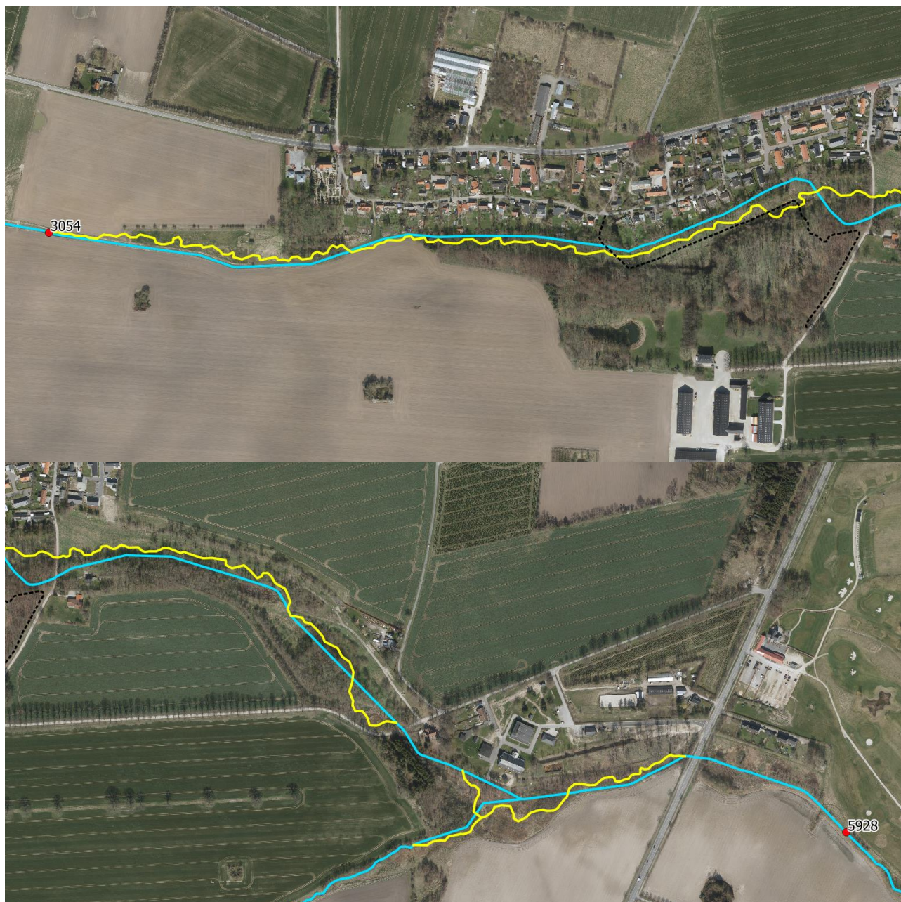
Figur 4.12: Forslag til etablering af nyt profil v. den fliselagte strækning fra st. 3.054-5.928. Nyt tracé er vist med gul streg. Eksisterende vandløb er vist med blå streg. Vandrestiens nuværende forløb er vist med sort stiptet streg. Baggrundskort: Ortofoto for år 2019 (GST).
