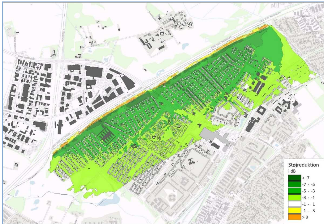
Figur 13. Den forventede støjreduktion ved at etablere en ny 12 meter støjvold
