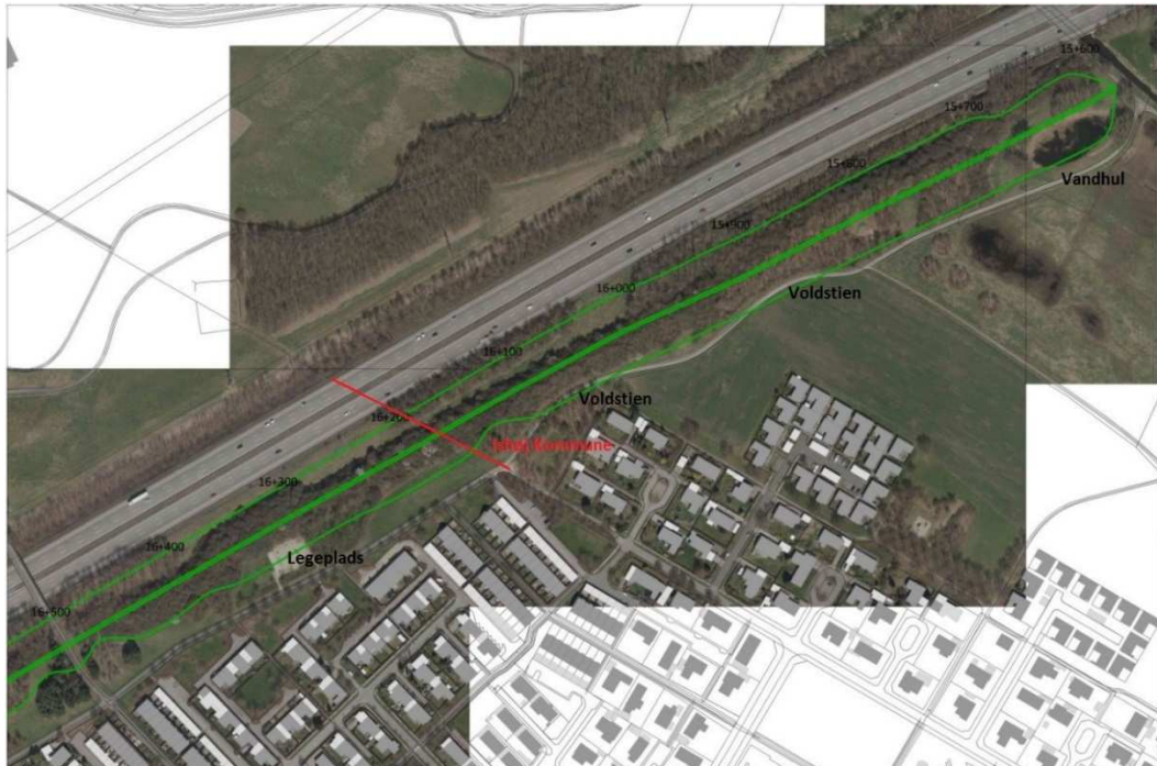
Figur 19. Fysiske udfordringer ved anlæggelse af støjvoldens etape 5. Omtrentlig placering af ledninger (røde) og andre anlæg (sort tekst).
