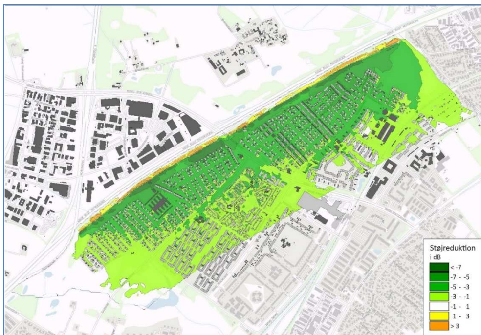
Støjreduktion med 12 meter høj støjvold
