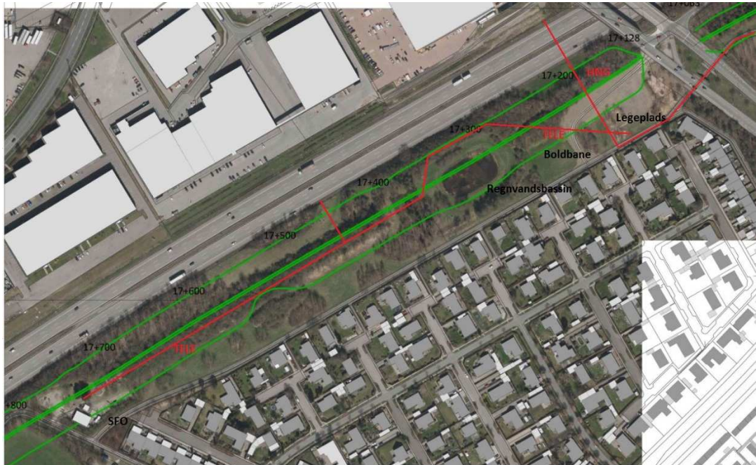
Figur 17. Fysiske udfordringer ved anlæggelse af støjvoldens etape 3. Omtrentlig placering af ledninger (røde) og andre anlæg (sort tekst).
