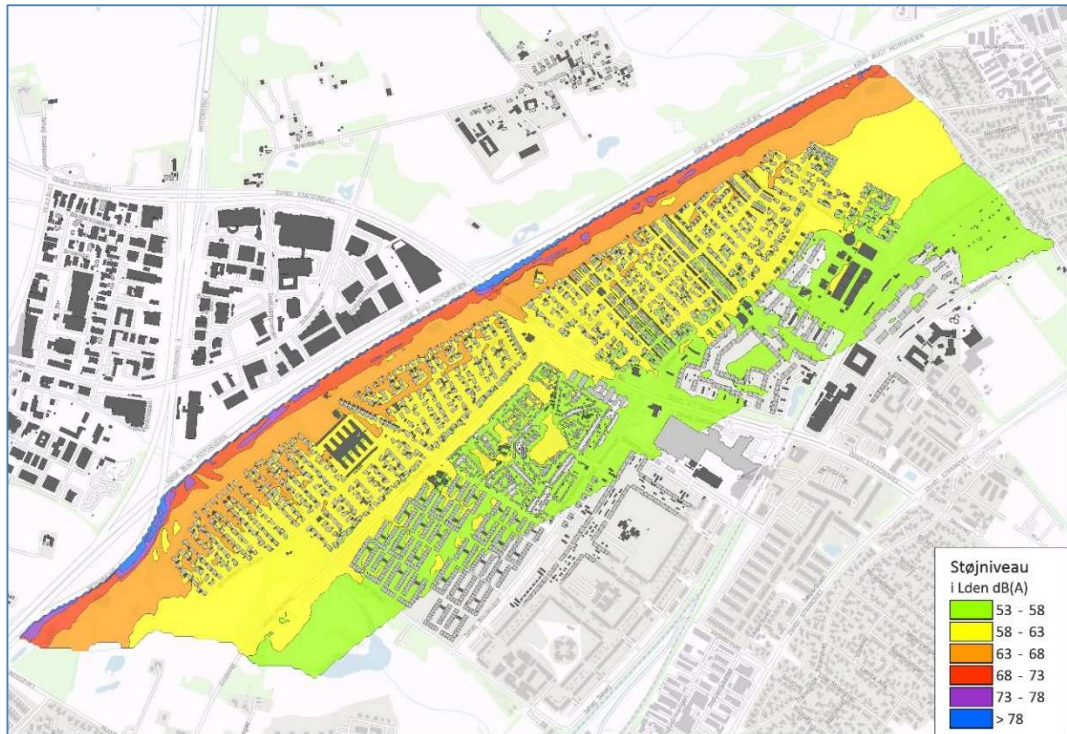
Figur 12. Støjkort som viser motorvejstøjen med en 4 meter høj støjskærm.
