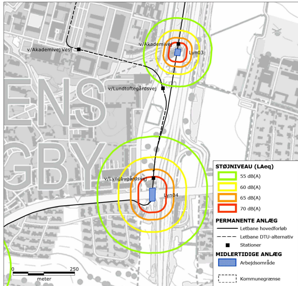
Bilag 3.a-3 | Støjkort for bro- og tunnelarbejder ved Lyngbygårdsvej i Lyngby-Taarbæk Kommune.
