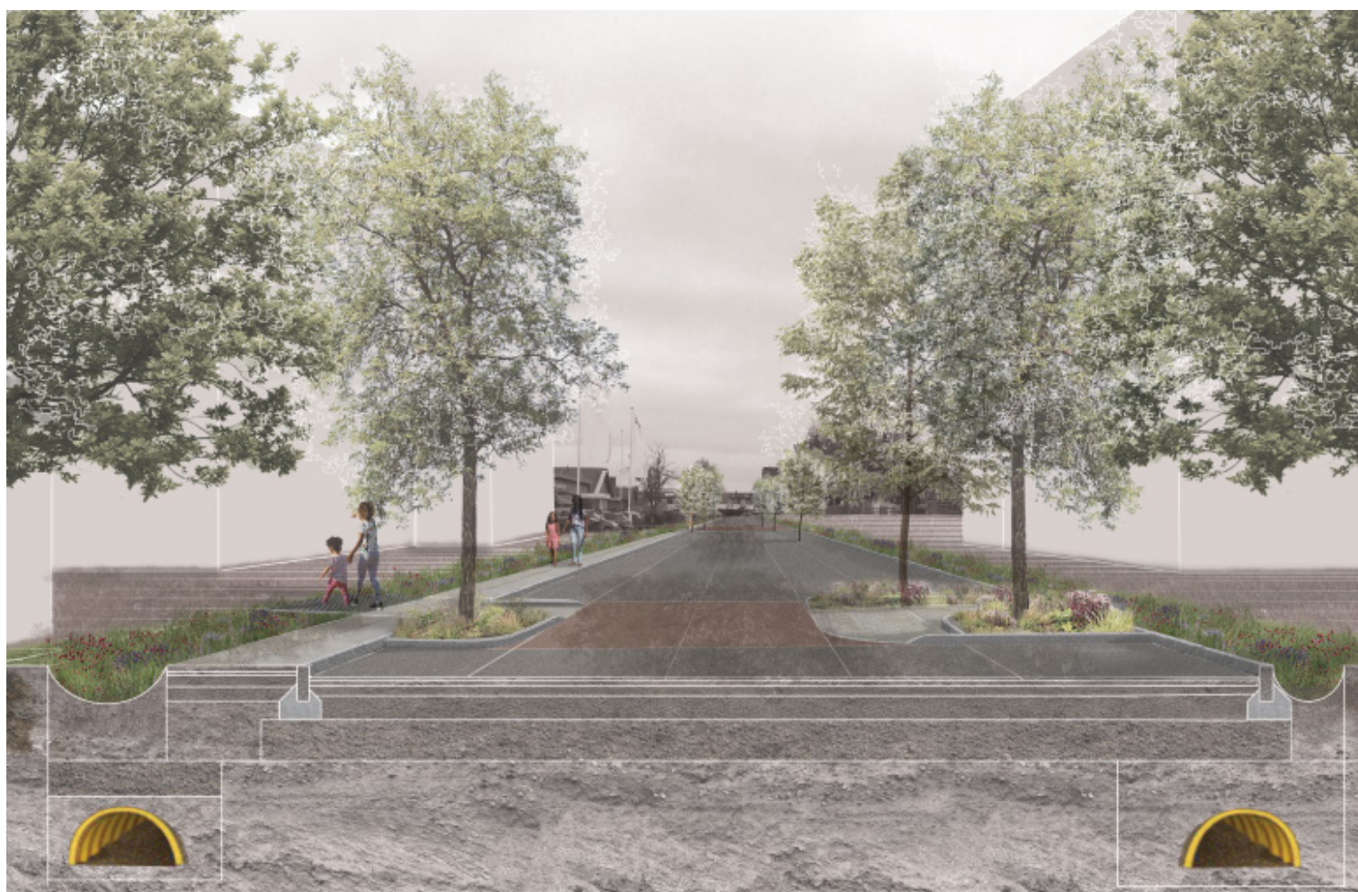
Opbygning af klimavej. Illustrationerne er udarbejdet af SWECO for Ishøj Forsyning i samarbejde med Ishøj Kommune.
