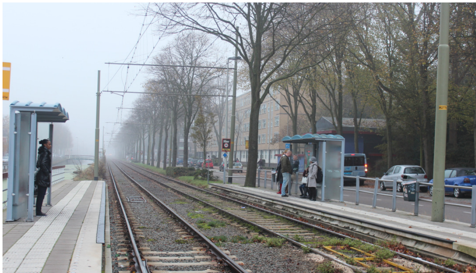
Figur 3-23 | Eksempel på sideperron fra Haag.
