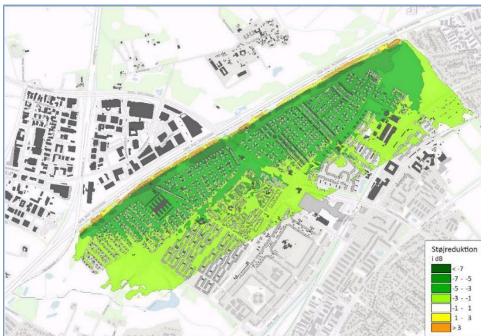
Figur 7-3 Den forventede støjreduktion ved etablering af en ny 12 meter høj støjvold. SWECO 2017
