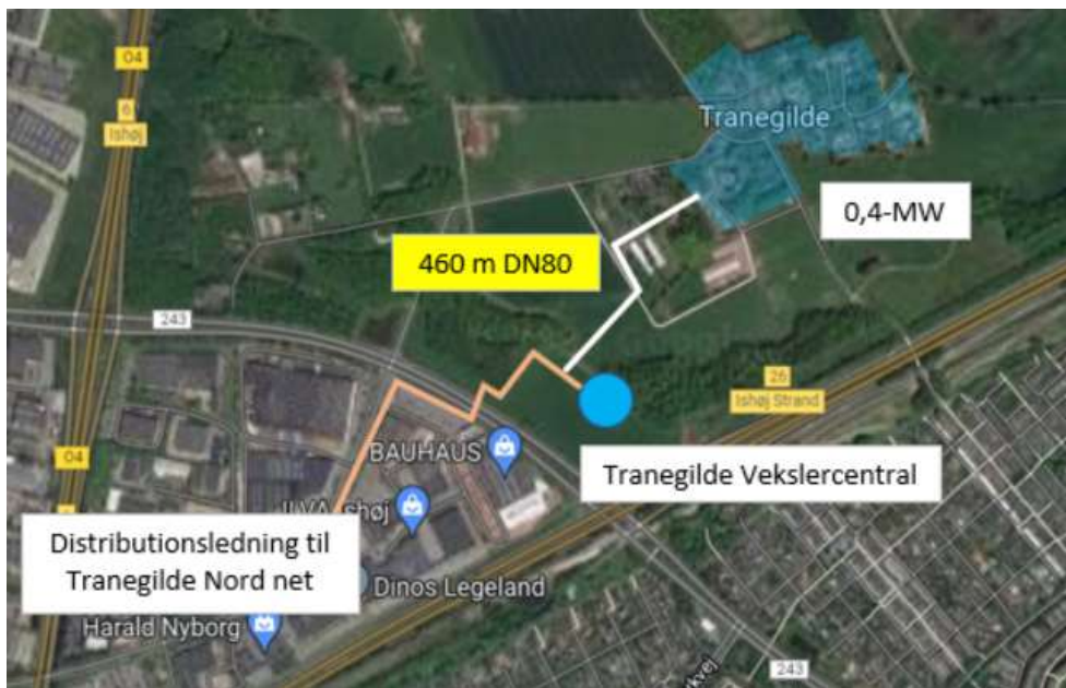
Figur 5 – Forslag til forsyningsledning til Tranegilde landsby
