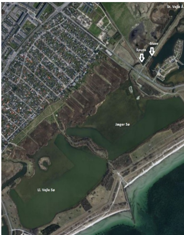
Figur 6. Placering af sluse og spunsvæg ved Store Vejle Å's udløb i Ishøj Havn.
