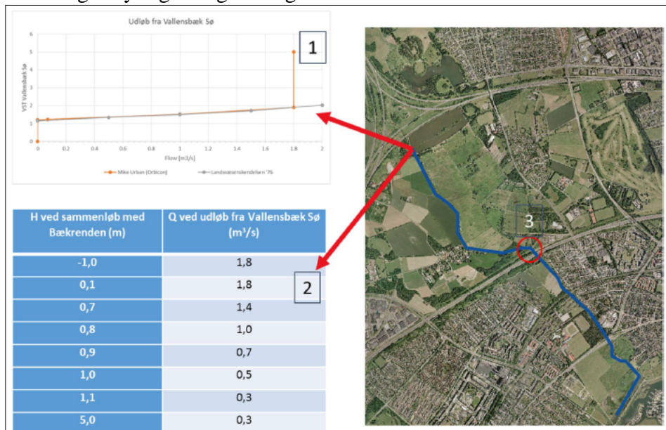
Figur 8. Princip for fremtidig dynamisk regulering af udløb fra Vallensbæk Sø.
