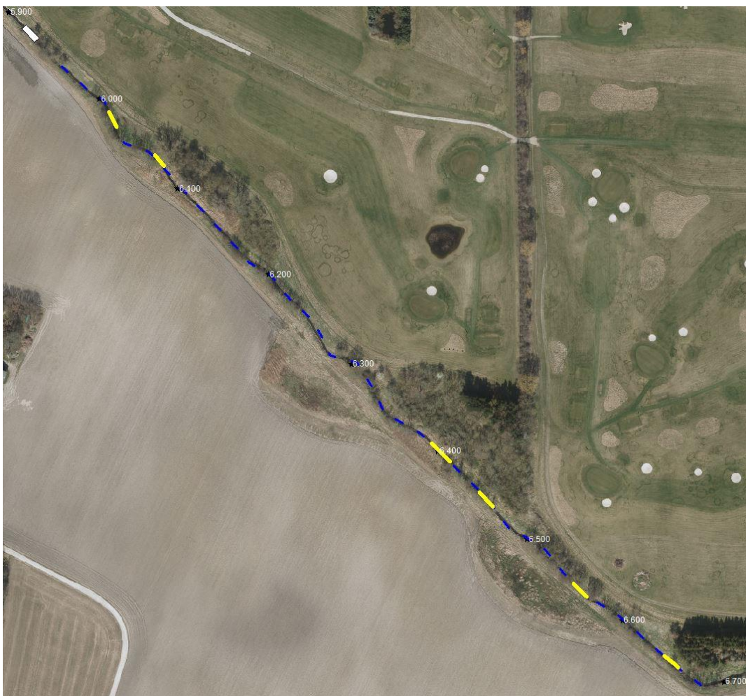
Kort 4: Anlægsarbejder på st. 5928-6752. Blå stiplet linje = skjulesten og grus. Gule streger = gudebanker. Hvid firkant = sandfang som kommunen kan vælge at etablere for egne midler.
