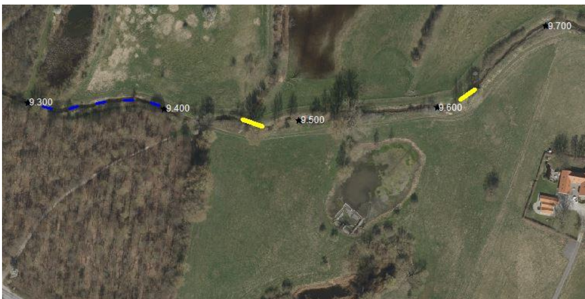
Kort 7: Anlægsarbejder på st. 9300-9680. Blå stiplede linje = skjulesten og grus. Gule streger = gydebanks.
