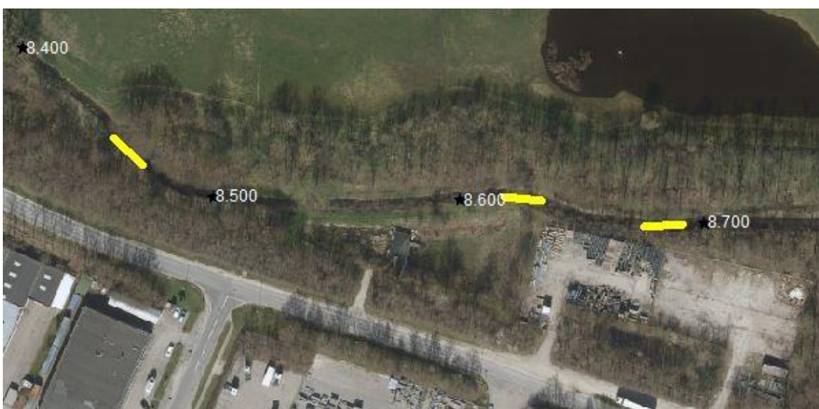
Kort 6: Anlægsarbejder på st. 8350-8700. Gule streger = gydebanks. Mere groft substrat ved Pile Mølle ned til Motorvejen grus og skjulesten.
