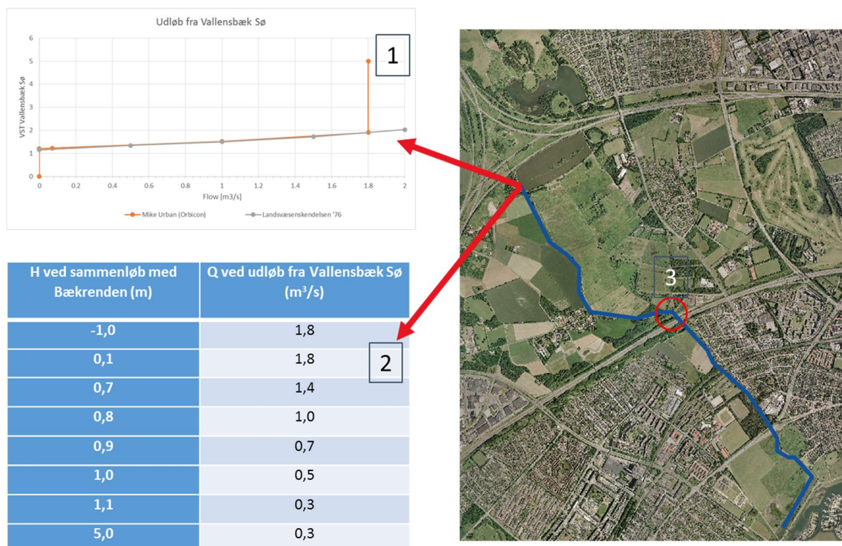
Figur 7. 1) Eksisterende regulering fra Vallensbæk sø (gul) samt regulering jf. kendelsen fra 1973 (grå); 2) Foreslået regulering af udløbet baseret på vandstand ved sammenløb af åen og Bækrenden; 3) Placering af eksisterende vandstandsmåler VA5, hvor det installeres en niveauføler der skal styre udløbet fra søen
