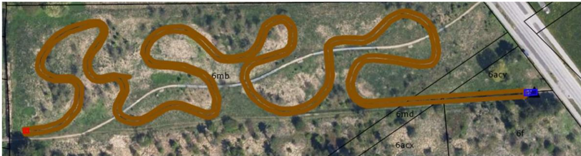
Figur 2: Udformning af Skovmosen. Det blå område markerer indløbet, hvor olieudskiller er placeret. Det røde område markerer udløbet, hvor vandbremse er placeret, inden vandet ledes til Bækrenden.
